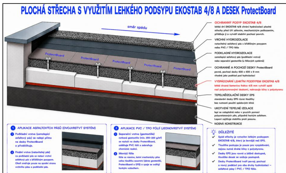
Obr. 1 Příklad využití systémových desek ProtectBoard a podsypu EKOSTAB ve skladbě plochých střech – vytvoření rychlé pochůzní spádové vrstvy
